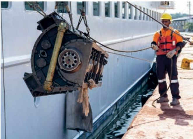
Der kaputte Motorblock der Doulos Hope wird per Kran aus dem Schiff gehoben
